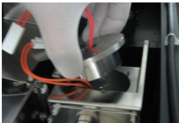
12. 从灯罩上取下Lamp。 Lamp有3个M3螺丝固定。
